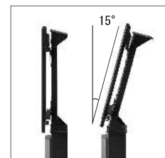
金具取付向きで2角度対応 垂直/傾斜=0°/15°
